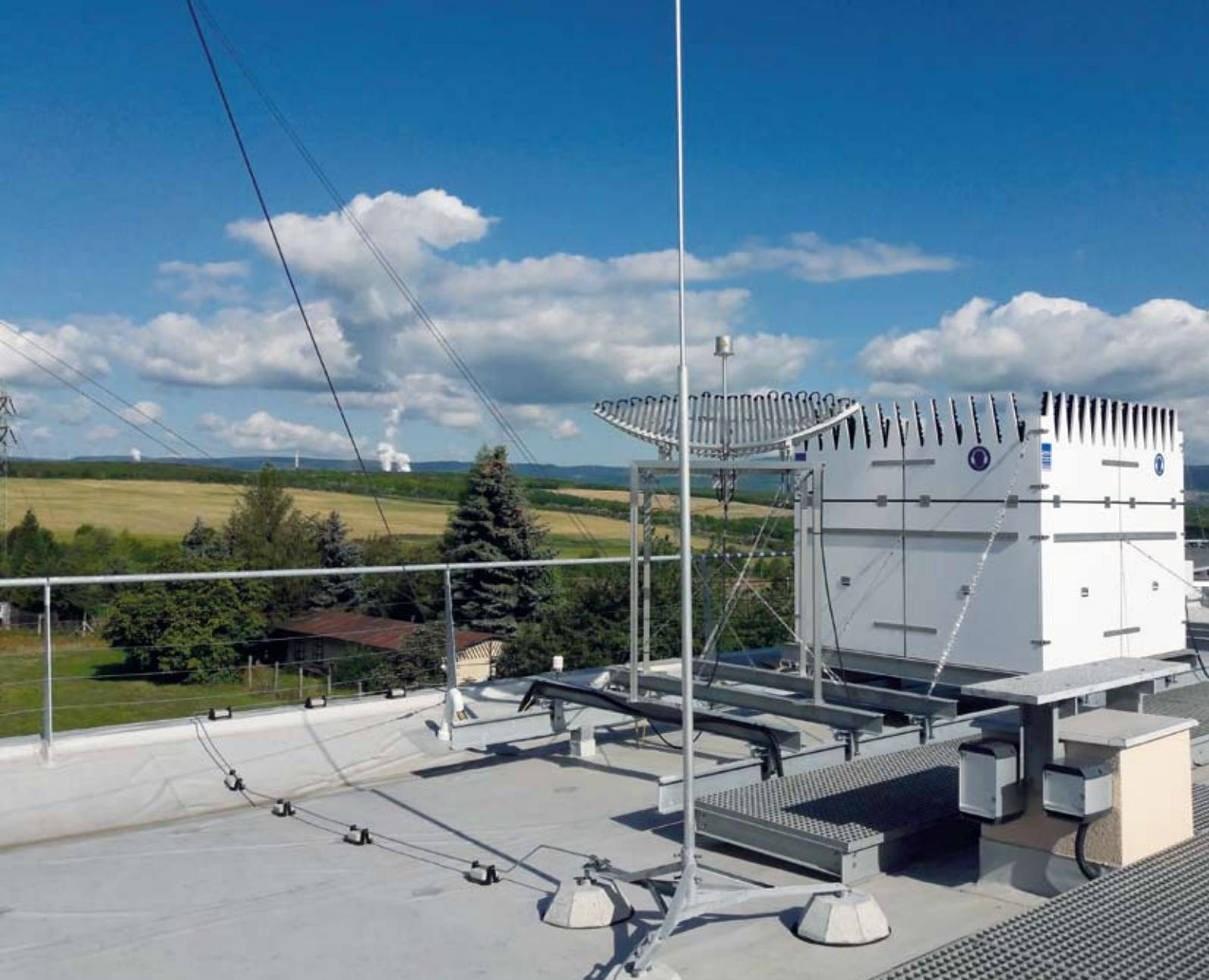
▲ Sistema radioacústico (Doppler SODAR – Sonic Detection and Ranging) usado para controlar los límites de capa atmosférica en el observatorio en Tušimice.
