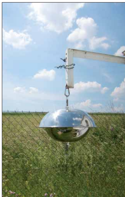
▲ Jednoduchý, avšak velmi účinný nástroj pro pasivní vzorkování vzduchu a zjištění kontaminace POPs.
