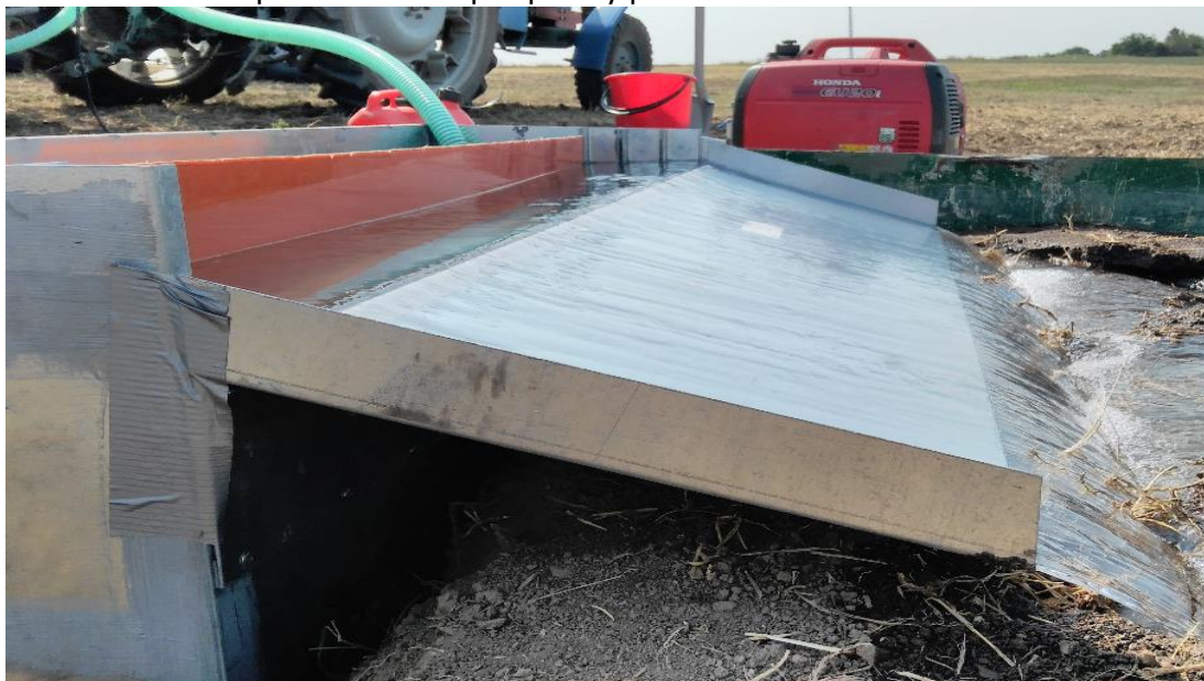
Obr. 12: Prodloužená přelivná hrana pro plošný přeliv
