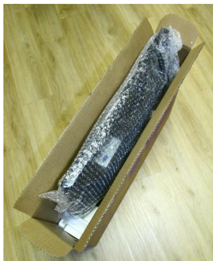
Obrázek 4 – Před vložením do krabice a fixací je LCD monitor obalen bublinkovou fólií
