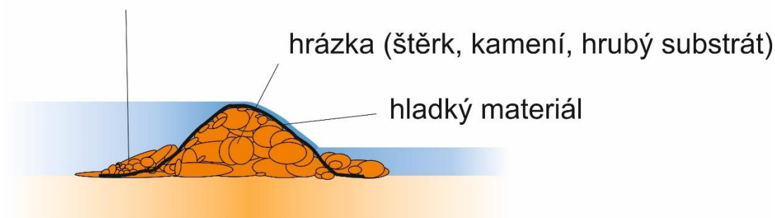
Obr. 34 Schematický náčrt vytvoření provizorní bariéry za účelem zabránění migrace raků proti proudu toku (bokorys). © D. Fischer
