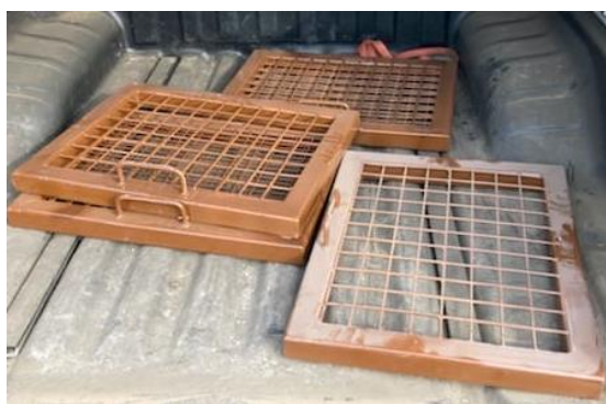
Obr. 22 Ukázka sít umístěných na vypouštěcí zařízení (požerák) Vysokopeckého rybníka v Bohutíně v roce 2020.
