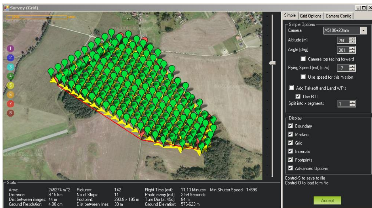
Obr. 10 Příklad plánování snímkové mise v prostředí open-source nástroje Mission planner. Na mapě jsou viditelné předpokládané pozice jednotlivých expozic.
